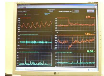
Exemple d'enregistrement d'activité nerveuse couplée avec des mesures de pression artérielle et fréquence cardiaque
